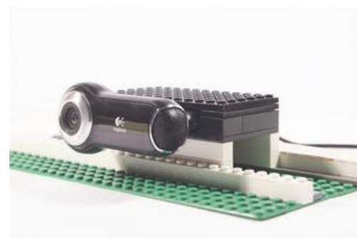
Le socle de la webcam peut facilement glisser sur la rampe.
